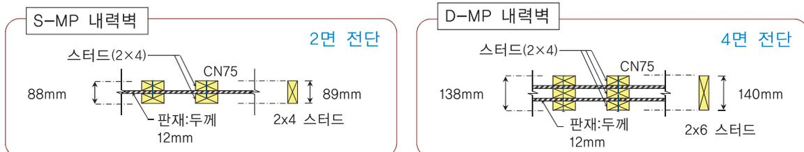
그림 1.1.7 MP 내력벽의 구성 (왼쪽 : S-MP 내력벽 / 오른쪽 : D-MP 내력벽)
