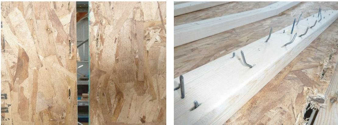
그림 3.1.8 전단 시험에 의한 MP 내력벽의 파괴 상황 (왼쪽 : 표면 재료의 지압 파괴, 오른쪽 : 못의 변형)
