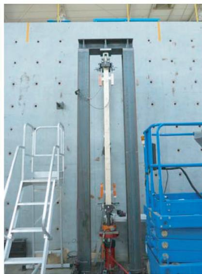
그림 3.2.1 압축시험을 위한 조립 기둥의 설치 방법
